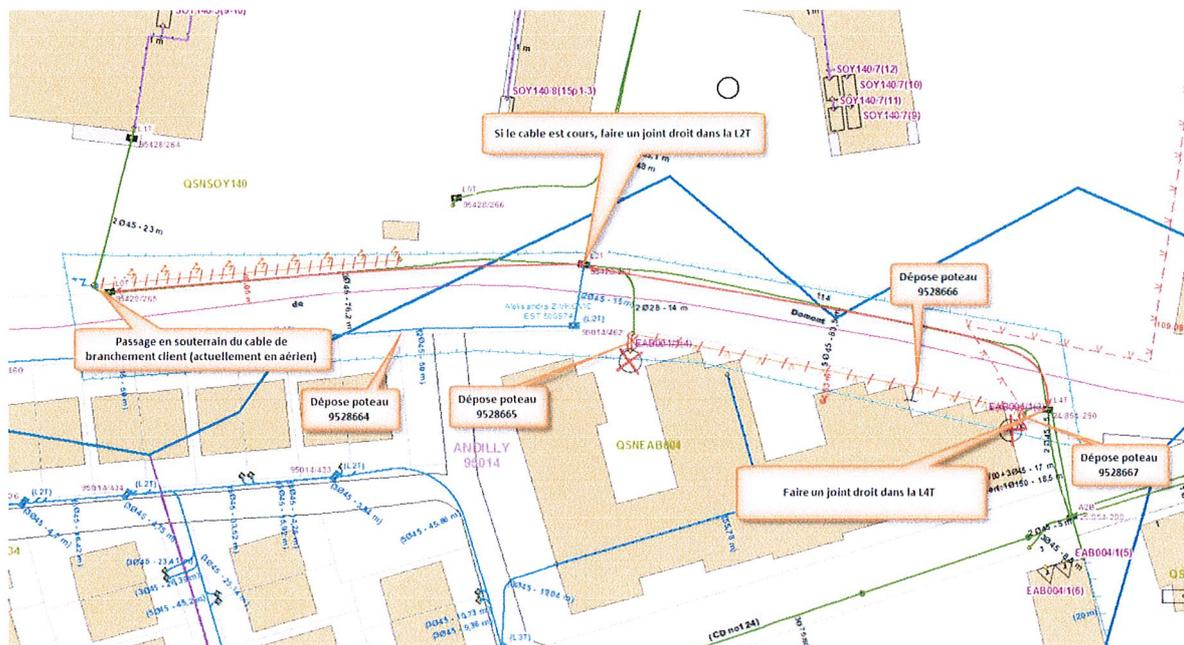
Dépose de poteau + dévoiement câble en souterrain chambre sur trottoir.
